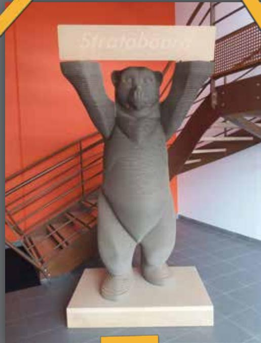
Stratoconception® est le procédé breveté de Fabrication Additive développé par CIRTES, depuis 1991, qui permet la fabrication, couche par couche, d'un modèle ou d'une pièce, sans aucune rupture de la chaîne numérique, sans limitation de forme, de matériau ou de taille.
